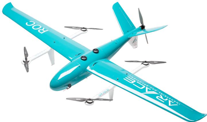
Abbildung 7: Arace ROC VTOL-Drohne (Quelle: Arace UAS, 2021)
